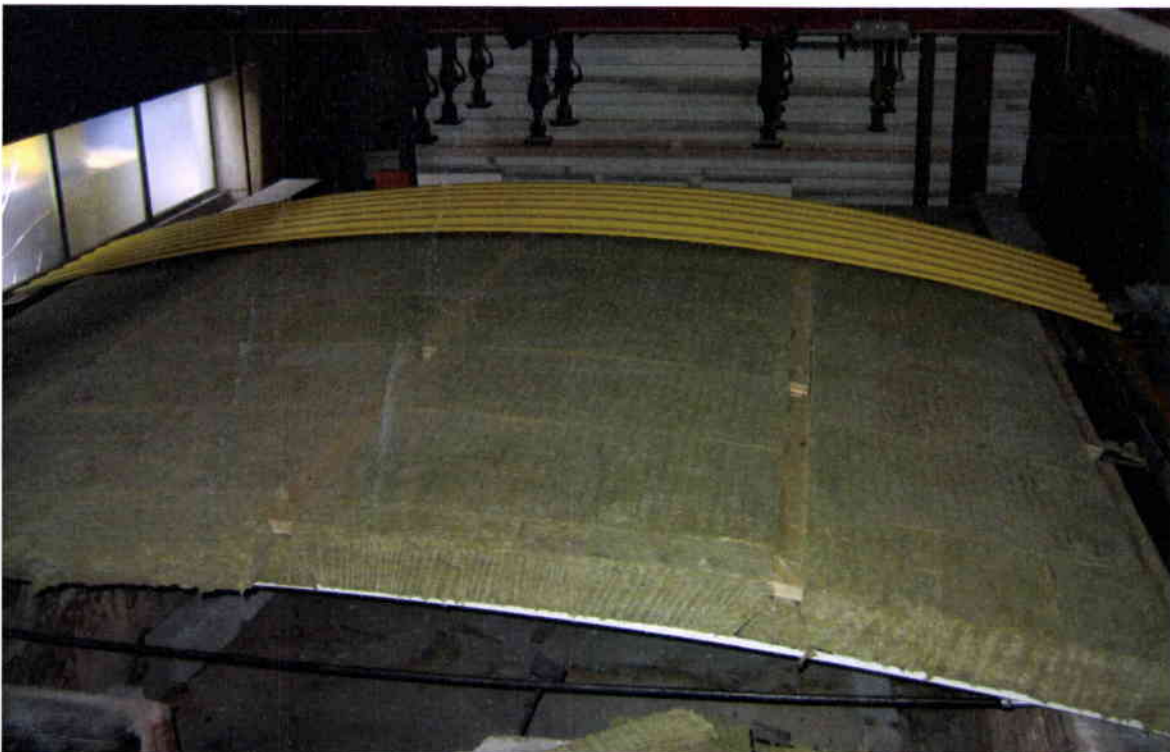
Bild 4: Ansicht des Probekörpers vor der Montage der Außenschale
