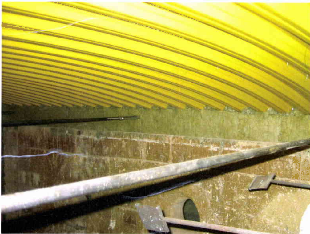
Bild 5: Wandanschlussbereich und Zugstangen an der feuerzugewandten Seite vor Versuchsbeginn
