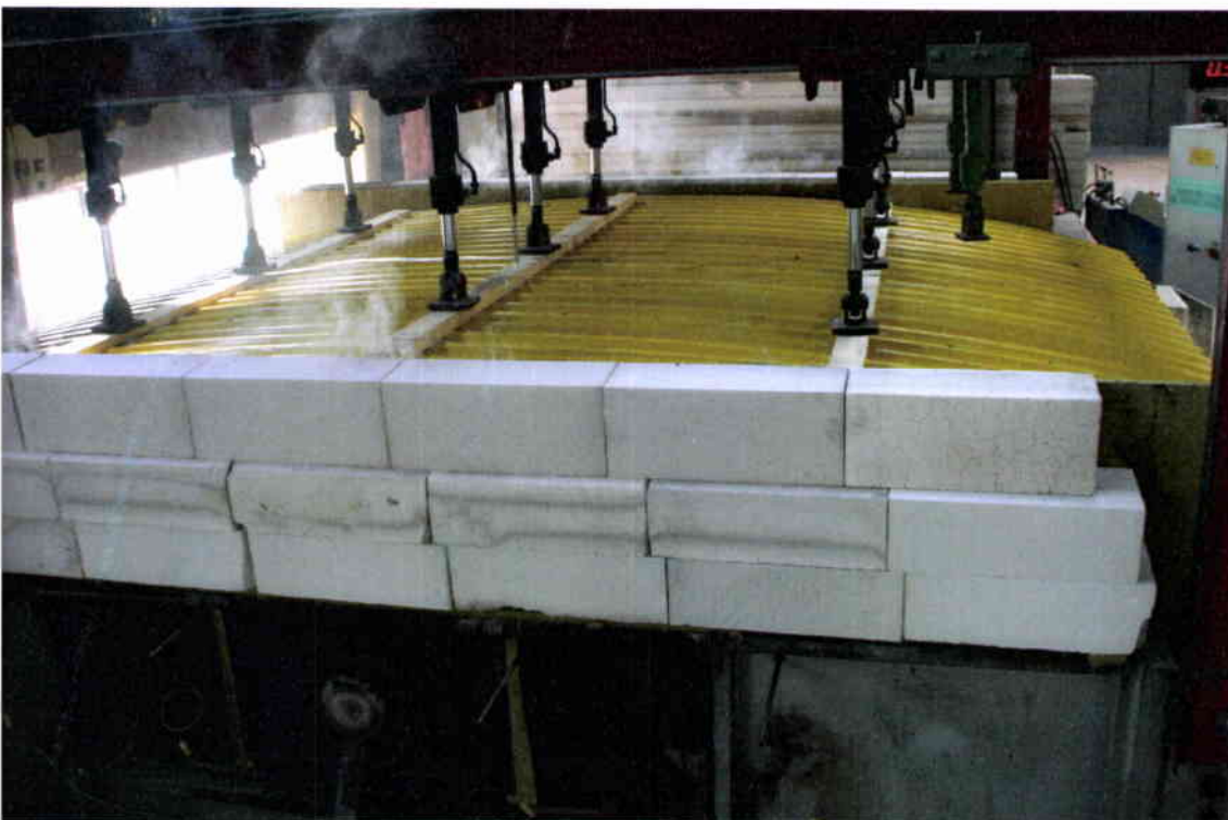
Bild 8: Zustand des Probekörpers in der 30. Versuchsminute
