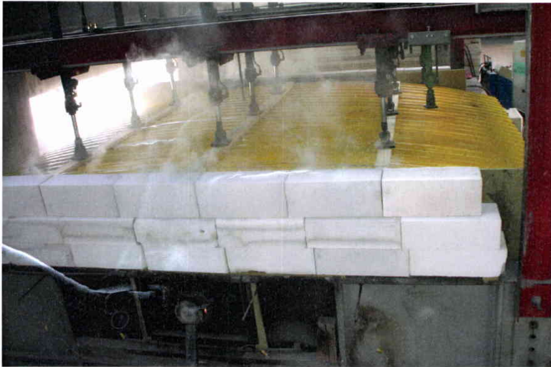
Bild 9: Zustand des Probekörpers in der 60. Versuchsminute
