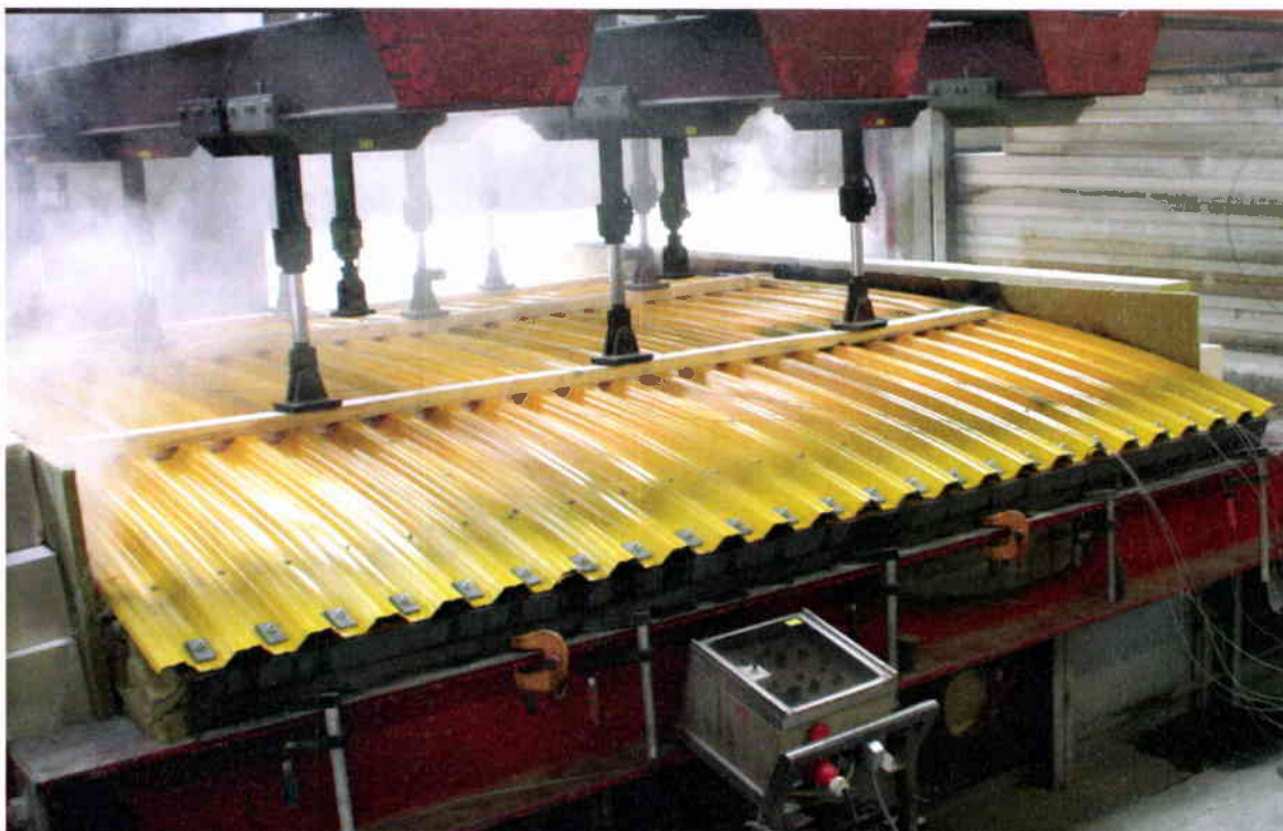
Bild 12: Zustand des Probekörpers in der 98. Versuchsminute
