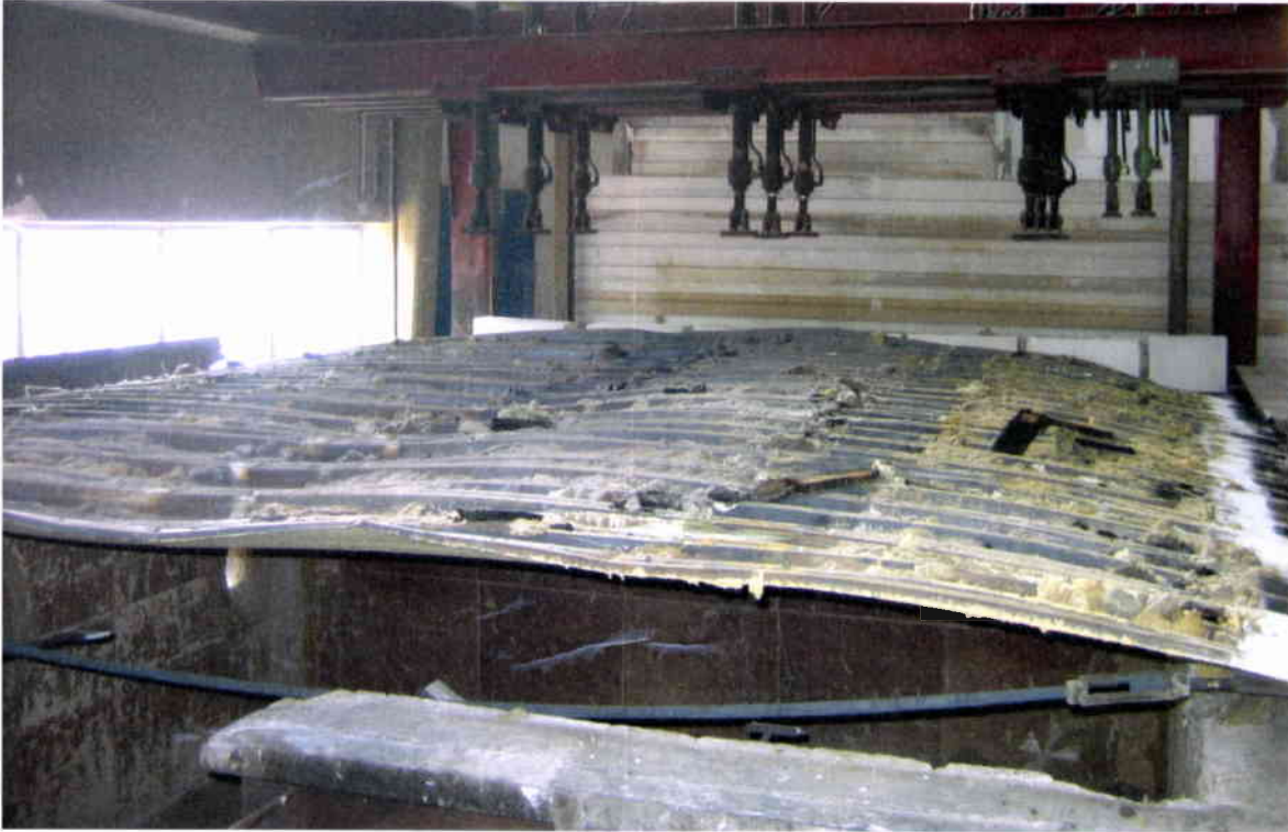
Bild 17: Ansicht des Probekörpers nach Abnahme der Außenschale bzw. Hutprofile und der Beseitigung der Steinwolle
